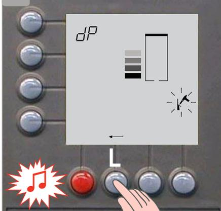
*El hervidor de agua está vacío. Pulse la tecla 'L'. (¡Cierre el grifo!)*
