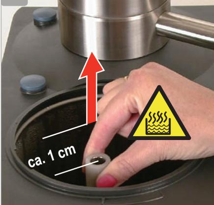
*Tire del conducto de desbordamiento hacia arriba por el manguito corto para vaciar completamente el hervidor. (¡Grifo abierto!).*
