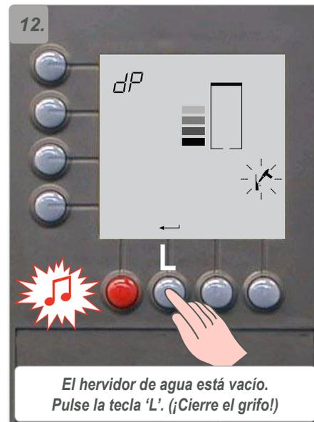
El hervidor de agua está vacío. Pulse la tecla 'L'. (¡Cierre el grifo!).
