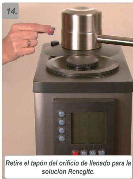
Retire el tapón del orificio de llenado para la solución Renegite.
