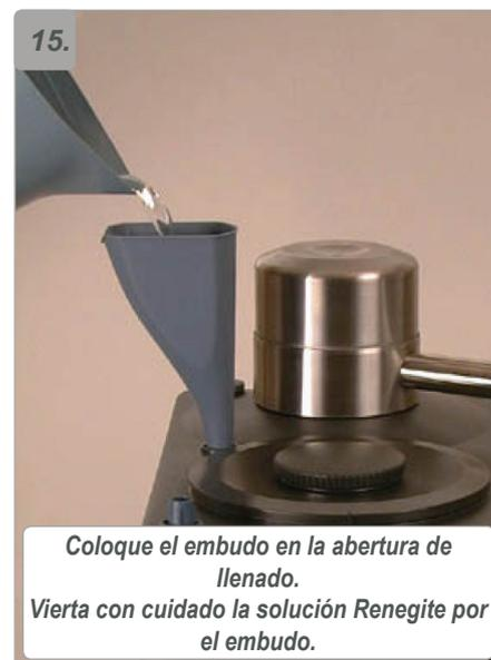
Coloque el embudo en la abertura de llenado. Vierta con cuidado la solución Renegite por el embudo.
