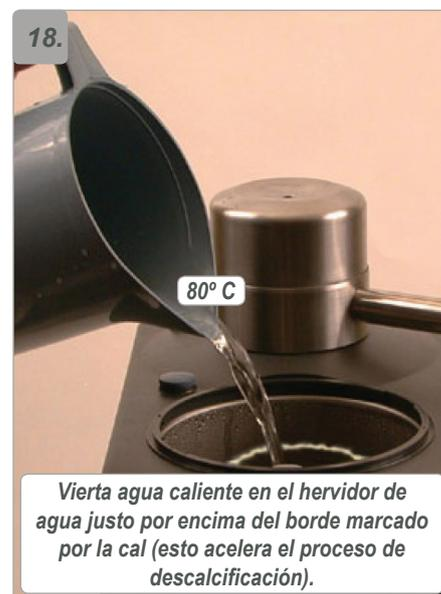
Vierta agua caliente en el hervidor de agua justo por encima del borde marcado por la cal (esto acelera el proceso de descalcificación).
