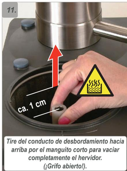
Tire del conducto de desbordamiento hacia arriba por el manguito corto para vaciar completamente el hervidor. (¡Grifo abierto!).
